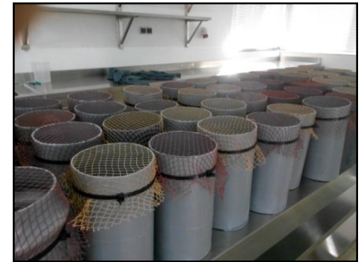
Tubos PVC 25 cm de comprimento e 14-16 cm de diâmetro
