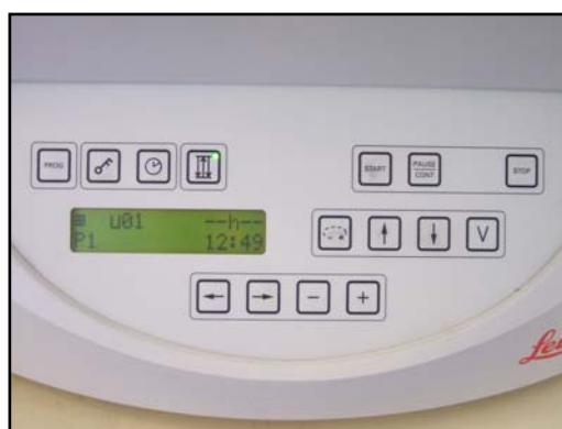
C – Processador de tecidos. Sistema de programação
