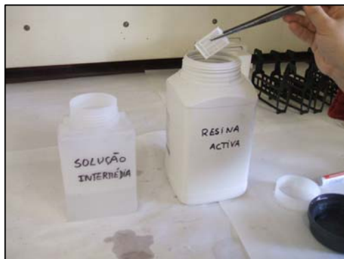
C – Colocação na resina activada
