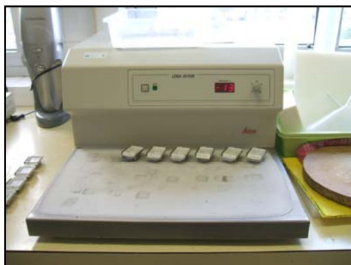
E – Colocação dos moldes na placa fria
