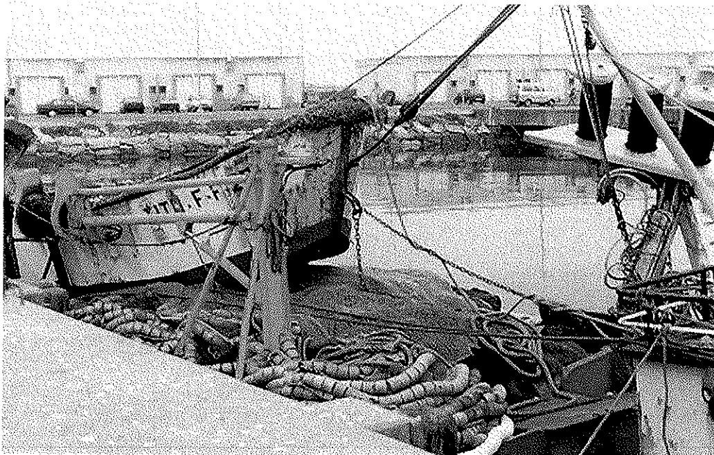
Figura AIII-9 – Estivador montado em estrutura fixa e chalandra sobre a rede de cerco.
