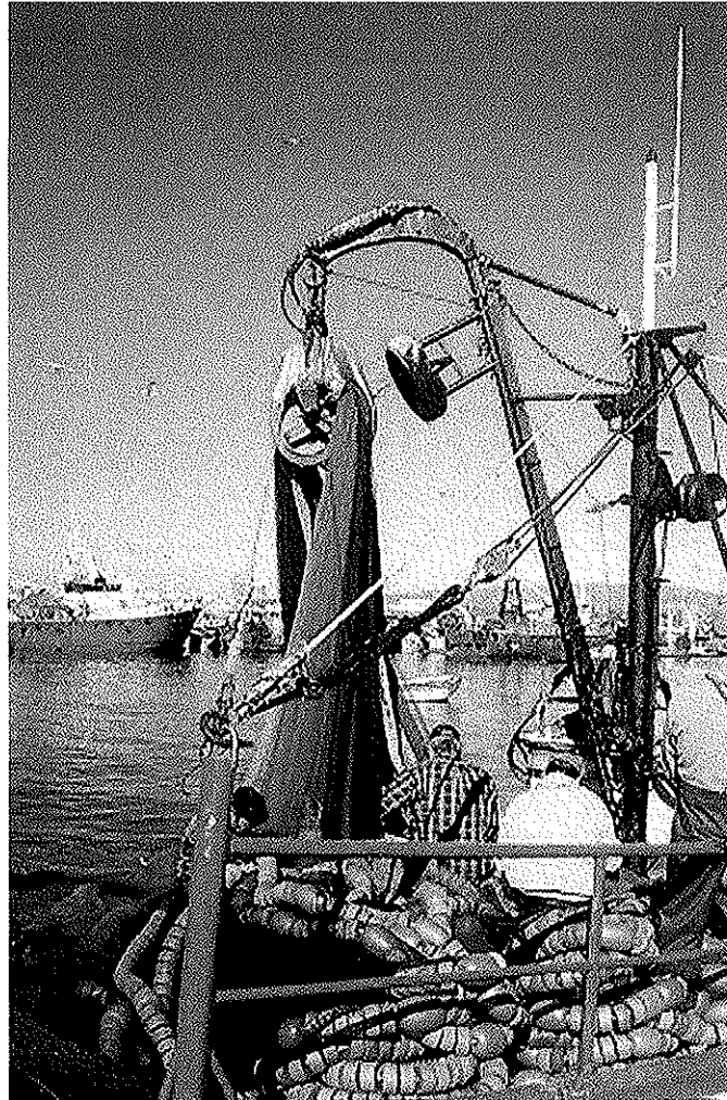
Figura AIII-7 – Alador de rede montado em estrutura fixa.
