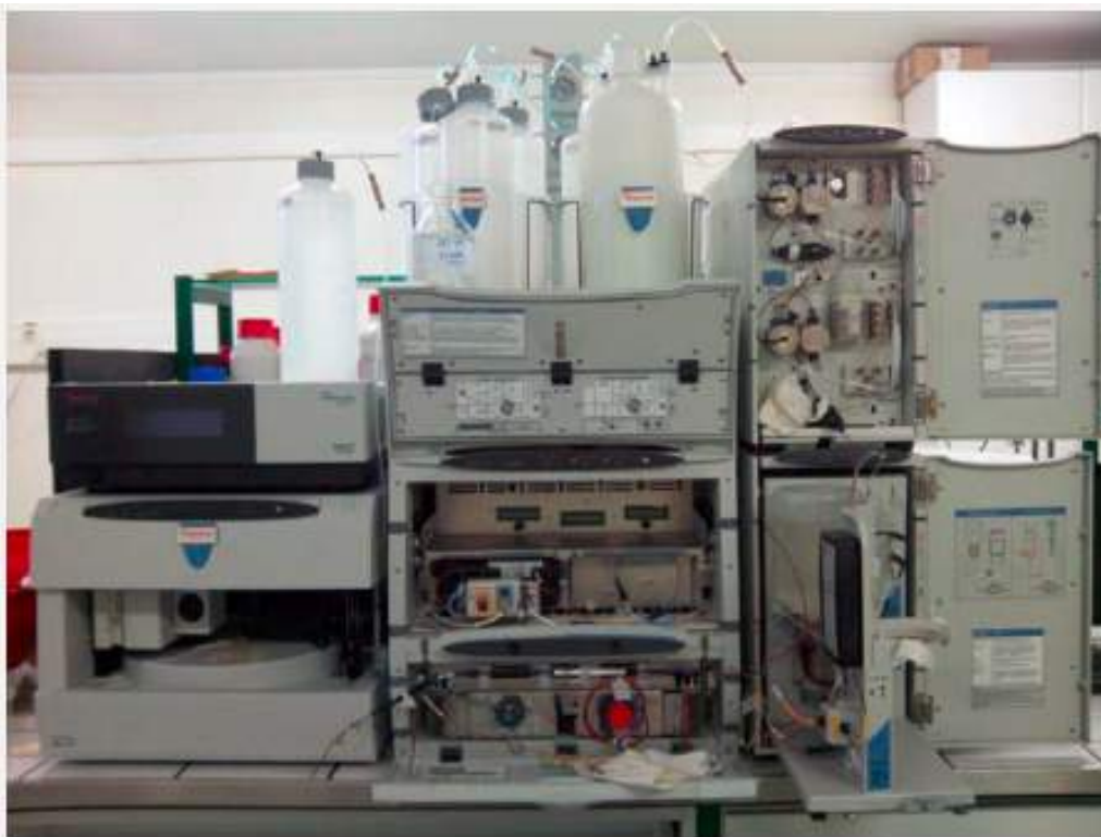
Figura 4 – Detalhe do interior do cromatógrafo iônico Dionex 5000+ com detector de condutividade e supressor iônico.
