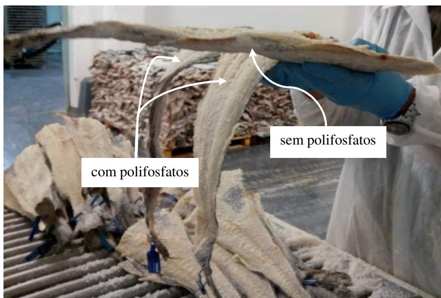
Figura 13 - Efeito da adição de polifosfatos no aspeto e rigidez do bacalhau após a secagem industrial por um período de 67 h.
