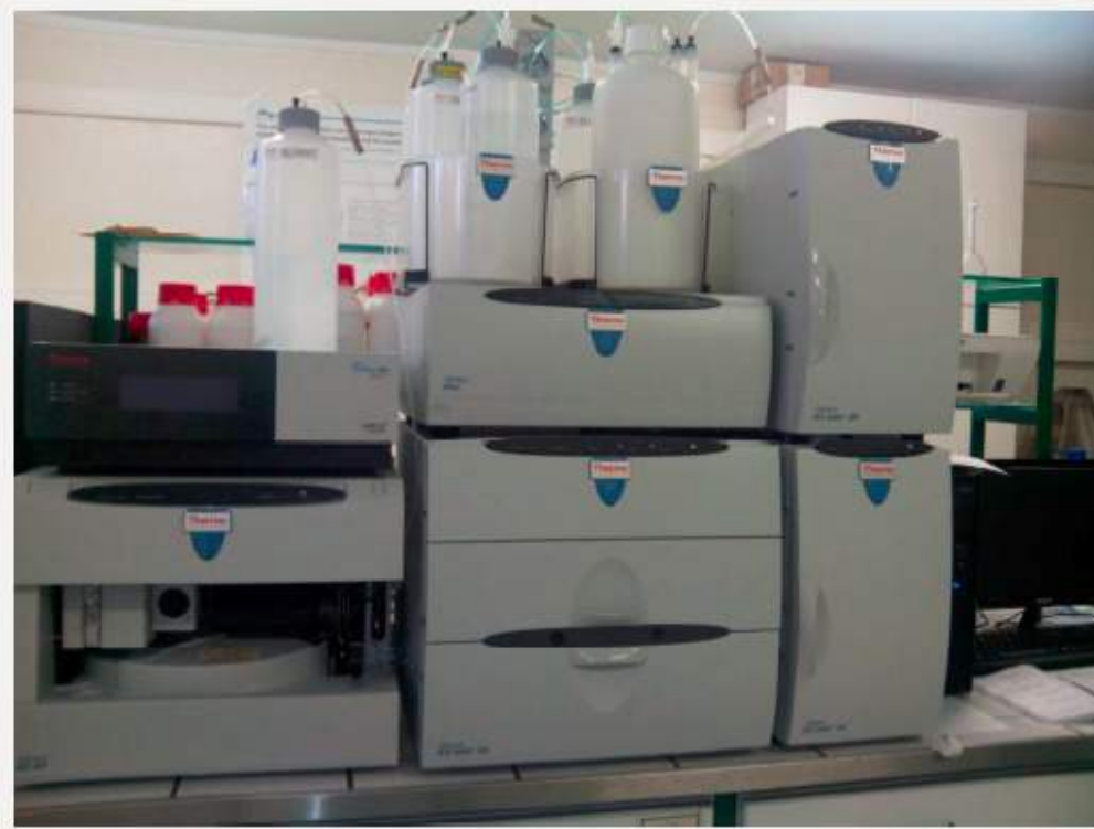
Figura 3 - Cromatógrafo iônico Dionex 5000+ com detector de condutividade e supressor iônico.
