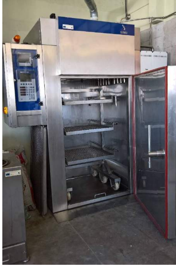
Figura 2.1.2 – Defumador industrial SIMIA S1001 (Simia, Lda, Montijo, Portugal), com 24 kW de potência, equipado com controlador de ventilação, humidade e temperatura JUMO Imago F3000 (Fulda, Alemanha).
